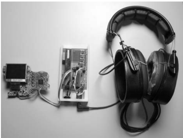
図 4 本作品で使用したデバイス （左からモニター，定電流・制御回路，ヘッドホンに装着された電極）
